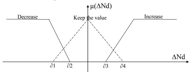
Fig. 12. Control output value
