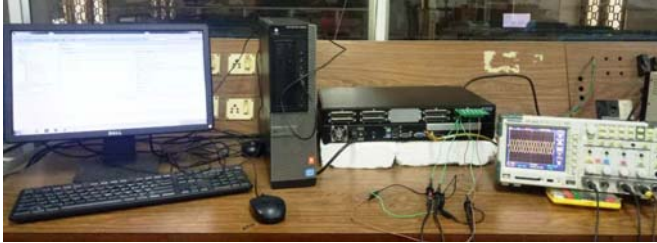
Fig. 17. RTDS using OP4150.
